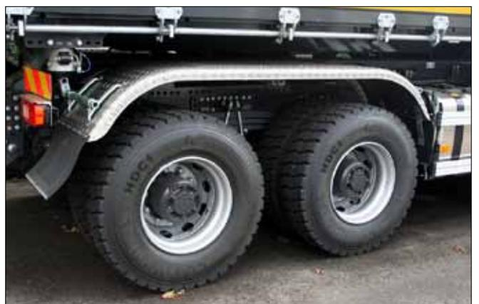
Formschöne Aluminium-Doppelachskotflügel schützen den Kipperboden, bei gleichzeitig guter Zugänglichkeit zur Bereifung.
