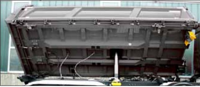
Die Bodengruppe – das Herzstück jedes Kippers. Durchgängig geschweißt und ca 50% mit breiten Spanten unterlegt. Kipperbodenblech aus 5 mm hochfestem Verschleißstahl VS 450. Der DK 3 ist für den hohen Nennlastbereich von 16000 kg ausgelegt und der DK 4 für 24500 kg.
