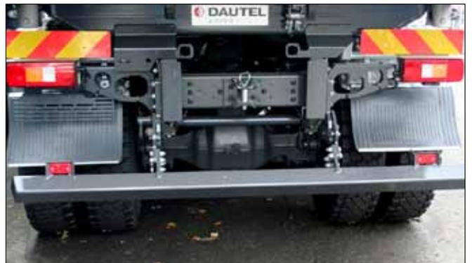
Der hochklappbare Unterfahrerschutz ermöglicht das Anfahren an gängige Straßenfertiger.
