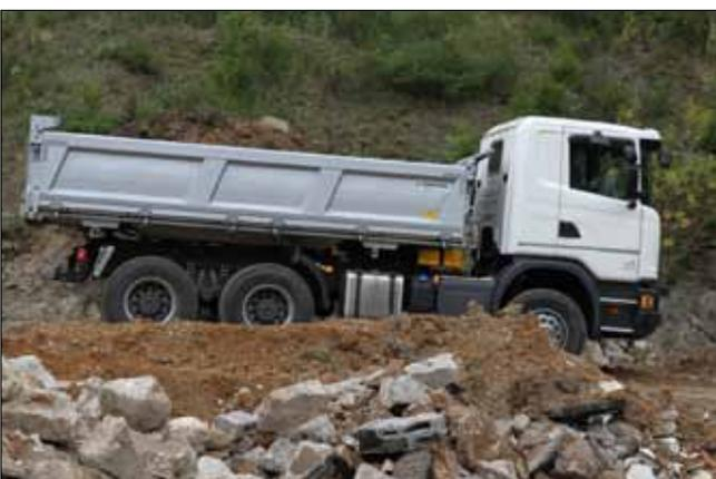
Robuste Stahlbordwand in verschleißoptimierter Ausführung für harte Einsatzbedingungen. Die Membran-Bauweise sorgt für Elastizität, die die beim Beladen auftretenden Stoßbelastungen absorbiert. Innenblech aus 4 mm hochfestem Verschleißstahl VS 450 für Seiten- und Rückbordwand.
